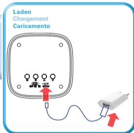
Kabel am Gerät und an einer Stromquelle anbringen. Indikatorlicht Leuchtet Rot und schaltet aus wenn das Gerät geladen ist.
